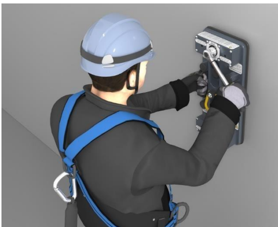
Maak de Zeskantbouten van beide Drukpoten los
