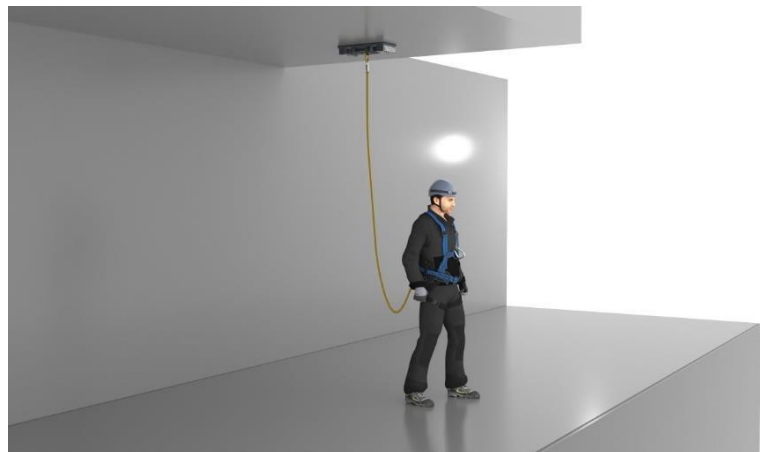
P-Tool aan plafond gemonteerd met operator bevestigd
