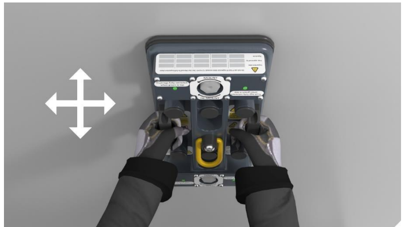
På dette tidspunkt kan P-Tool justeres i alle retninger.
